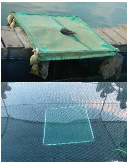
Ancho sebagai *feeding tray* adalah alat yang digunakan untuk mengontrol konsumsi pakan udang. *Feeding tray* berfungsi sebagai tempat pakan buatan, berukuran 1x1 m terbuat dari bahan hapa yang dilengkapi dengan rangka pipa paralon ¾ inchi, yang digantung horisontal membentuk seperti tangga mulai dari ketinggian 50-100 cm dari dasar wadah. Ancho diganti ± setiap 2 minggu. Perawatan ancho meliputi pencucian lumut yang menempel pada permukaan kassa, kemudian dijemur.
