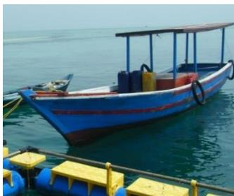
Perahu digunakan sebagai sarana transportasi yang terbuat dari fiber. Perahu dilengkapi dengan mesin kapal. Servis mesin kapal dilakukan setiap 3 bulan.
