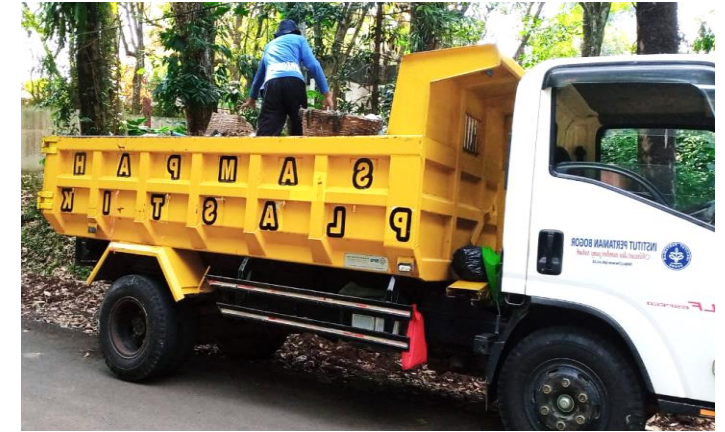
Dump Truck Kuning hidrolik kapasitas 5,76 m 3 Melayani 31 TPS curah dan 63 TPS container
