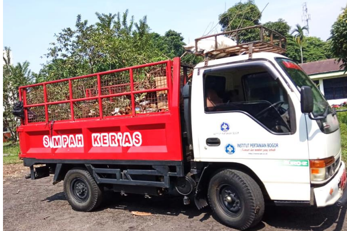
Truck Merah manual kapasitas 5,76 m 3 ; Melayani 31 TPS curah dan 63 TPS container
