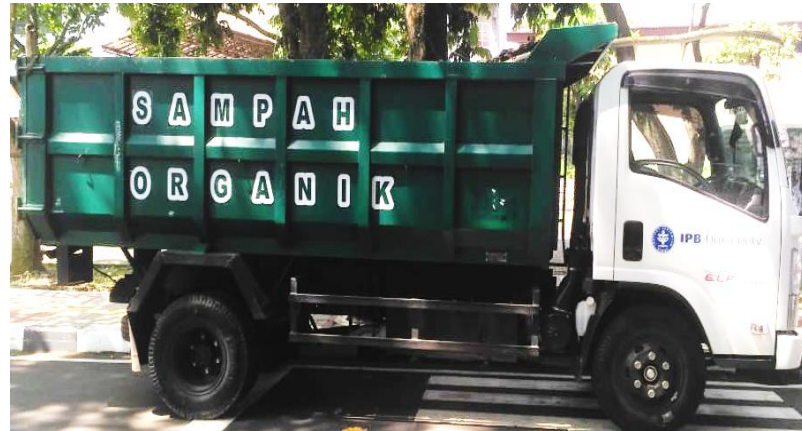
Dump Truck Hijau hidrolik kapasitas 7,2 m 3 ; Melayani 31 TPS curah dan 63 TPS container + Hasil sapu, babat dan pangkas
